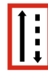
B3a Obligation de tenir le côté du chenal se trouvant à bâbord
