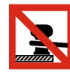
A7 Interdiction de s'amarrer à la rive du côté de la voie où le signal est placé
