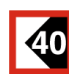
C5 Le chenal est éloigné de la rive droite ou gauche. Indiquer la distance en mètres
